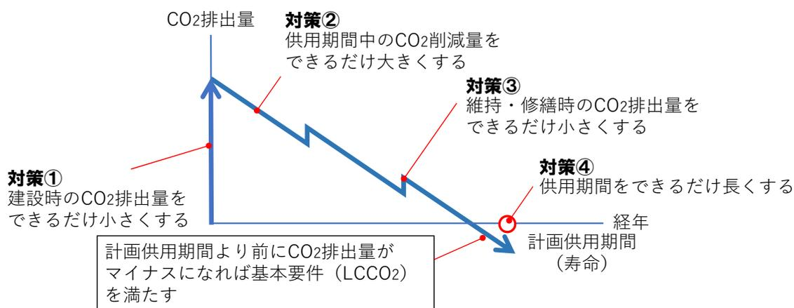
図1 基本要件(LCCO<sub>2</sub>)判定の概念図
