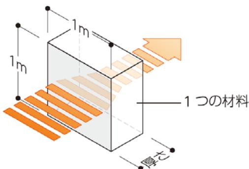
$$\text{熱抵抗 } R \text{ [m}^2 \cdot K/W] = \frac{\text{材料の厚さ } d \text{ [m]}}{\text{材料の熱伝導率 } \lambda \text{ [W/(m} \cdot K)]}$$
