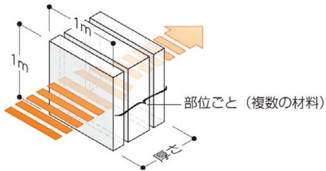
床、壁、窓などの部位の断熱性能を表わす値である。
