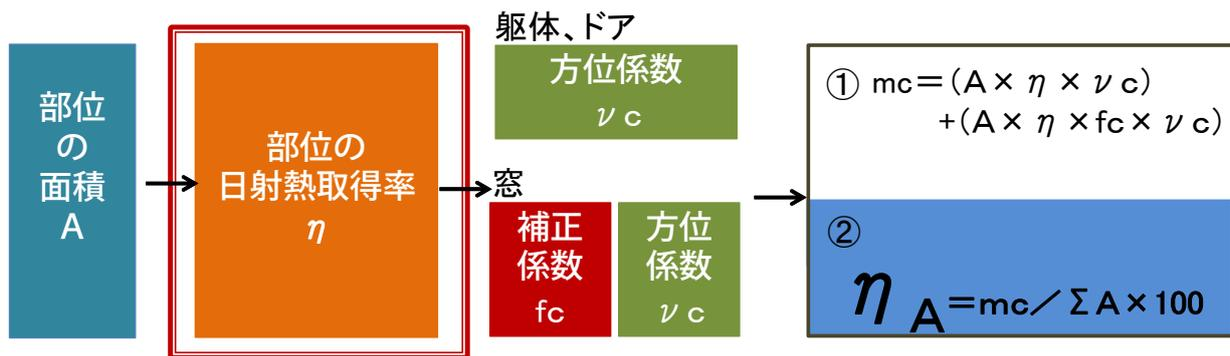
Step 2. 窓日射熱取得率  $\eta$  を求める
