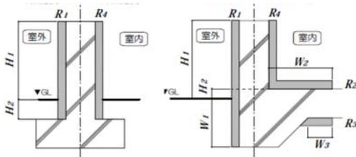
$R_1$ : 基礎等の立ち上がり部分の室外側に設置した断熱材の熱抵抗 (単位 $m^2K/W$ )
