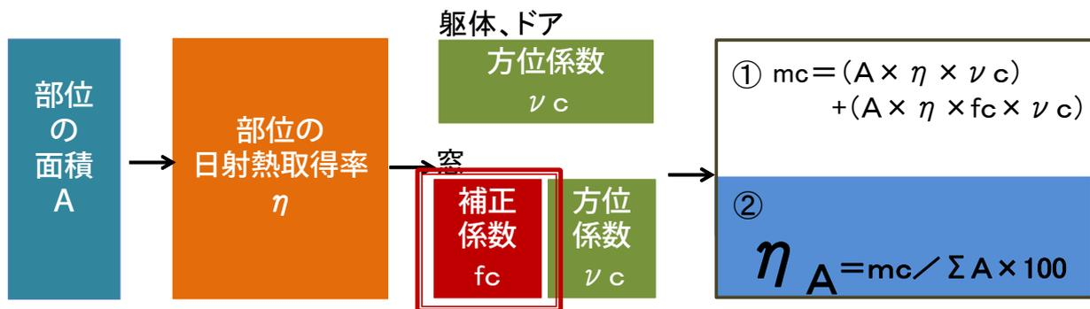
Step 3-1. 窓の補正係数  $f_c$  を求める  $\eta_A$  0763-1. 窓の補正係数  $f_c$
