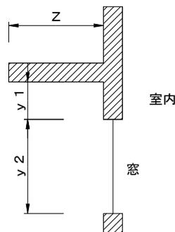
y1: 日除け下端から窓上端までの垂直方向の距離[mm]
