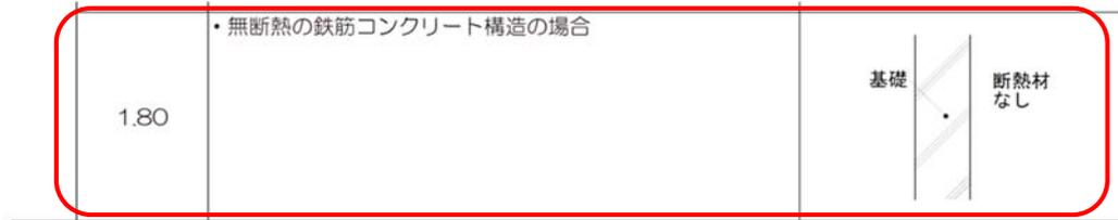
したがって、モデルプランの基礎の熱貫流率Uは、1.80 [W/(m<sup>2</sup>・K)]
